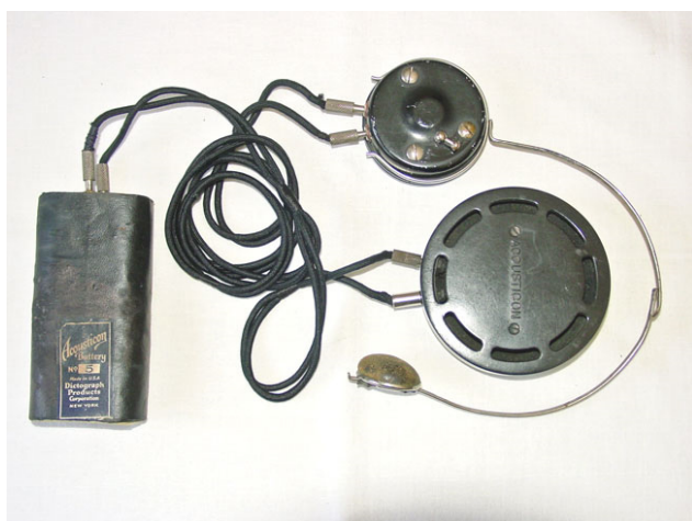
Kulkornshøreapparat med batteri – mikrofonen er den store cirkel, der blev båret uden på tøjet f.eks. i et knaphul
